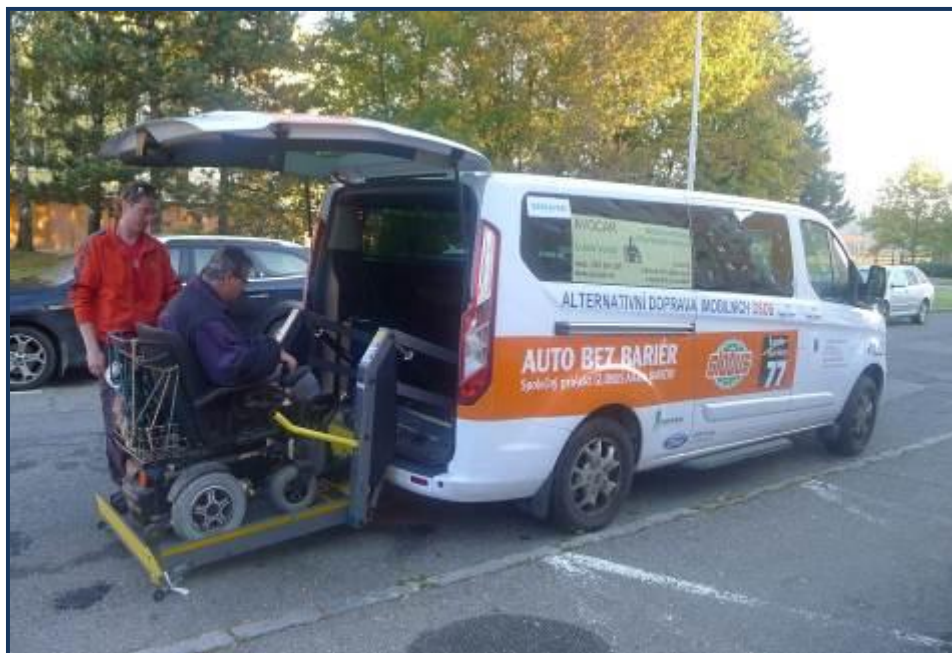
Nástup vozíčkáře na elektrickém vozíku pomocí hydraulické zdvihací plošiny
